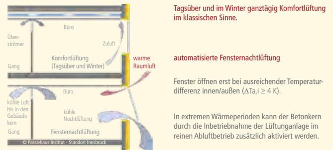
Systemcrosschnitt Lüftungs- und Kühlsystem
